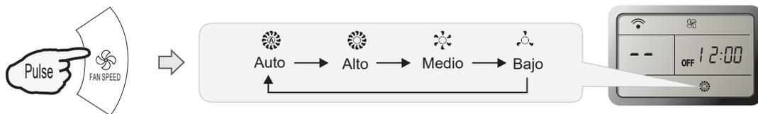
**Nota:** En el modo de **Ventilación**, solo están disponibles las velocidades **Alto**, **Medio** y **Bajo**. En modo **Deshumidificación**, la velocidad del ventilador es ajustada automáticamente. El botón **Fan Speed** es inválido en este caso.
